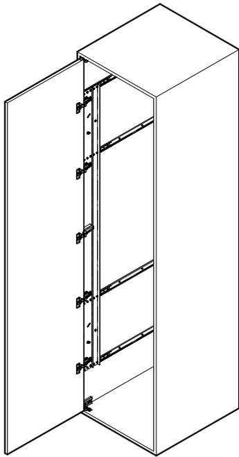
Nuevo y optimizado sistema para ocultar las puertas en los laterales de los muebles y armarios. Este kit de bisagras, barras y guías, ideados para puertas de hasta 2400 mm de altura y 20 Kg de peso, se ha desarrollado y mejorado, para un deslizamiento suave y continuo, evitando también el descuelgue de la puerta con sistema patentado.
